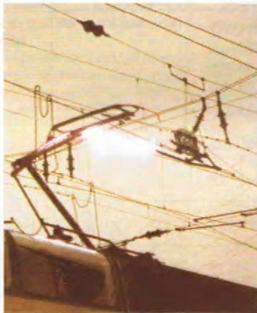
Bild 14: Stehender Lichtbogen am Streckentrenner.
